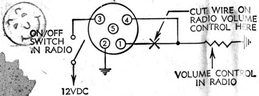
TYPICAL RADIO HOOKUP SHOWING TOP VIEW OF SOCKET IN RADIO
